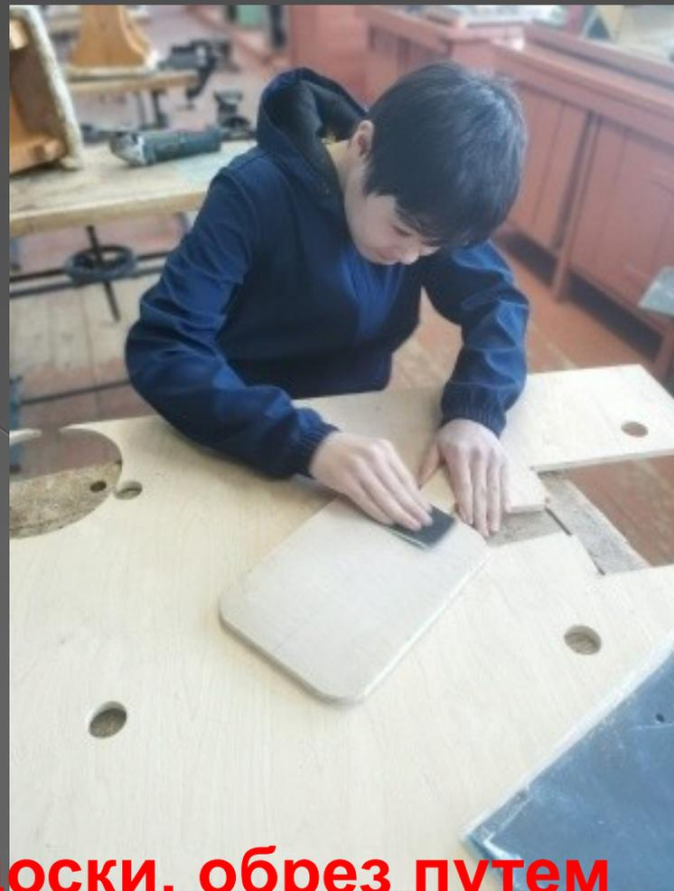
Рисование формы доски, обрез по пила и шлифовка наждачной бумагой
